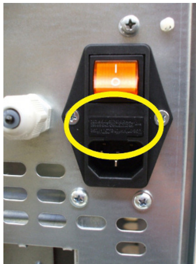
Fig. 43 - Porta com fusíveis a remover
