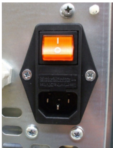
Fig. 19 - Presa elettrica con interruttore generale
