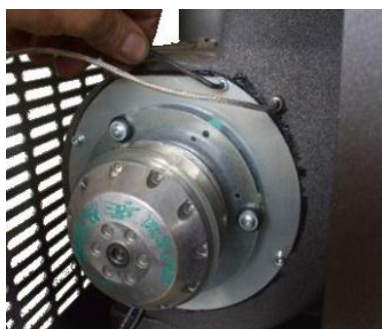
Fig. 35 - Nettoyage de l'aspirateur des fumées: phase 1
