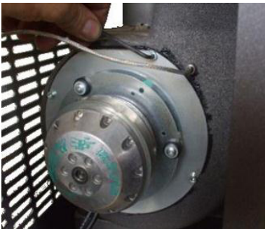
Fig. 35 - Fume fan cleaning: phase 1
