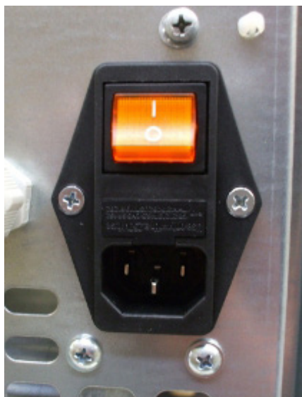
Fig. 19 - Tomada elétrica com interruptor geral
