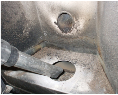
Fig. 28 - Καθαρισμός εσωτερικού μέρους δοχείου καύσεως
