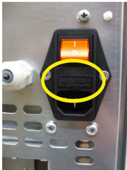
Fig. 43 - Trappe avec les fusibles à changer
