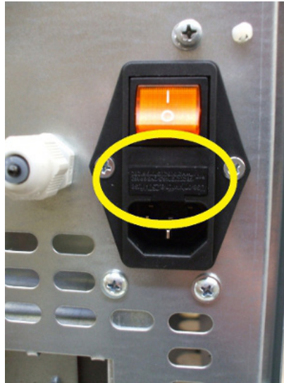
Fig. 43 - Sportellino con i fusibili da rimuovere
