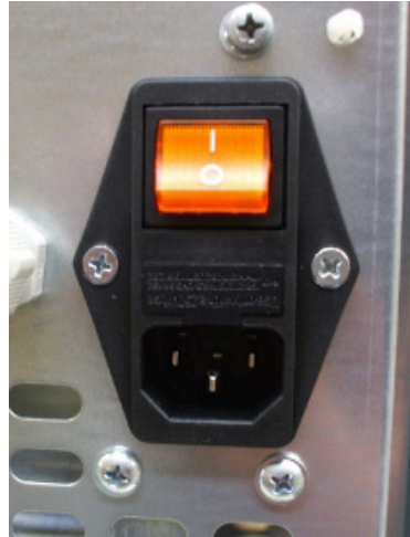
Fig. 19 - Toma de corriente con interruptor general
