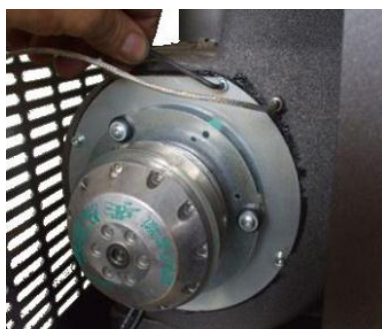
Fig. 35 - Limpieza del aspirador de humos: fase 1
