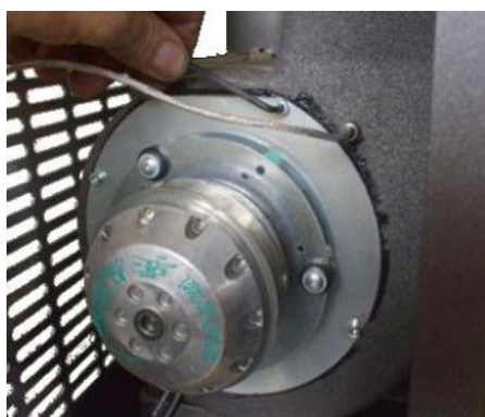
Fig. 77 - Reiniging rookgassenafzuiger: fase 1
