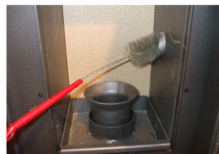
Fig. 70 - Reiniging met flessenwisser
